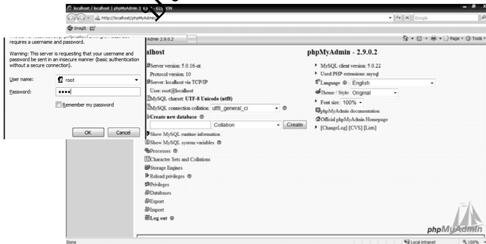
รูปที่ 12.6 หน้าจอแสดงการ Login เข้าใช้งานโปรแกรม PhpMyAdmin เพื่อเข้าสู่หน้าจอ PhpMyAdmin
