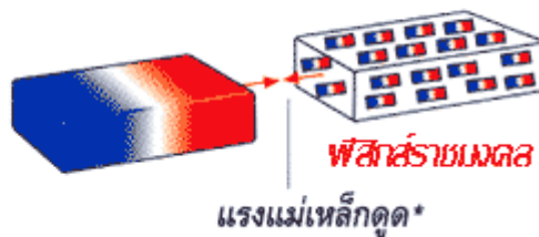
ภาพที่ 6 ภาพแสดงการเหนี่ยวนำแม่เหล็ก
